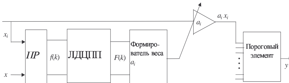
Рис. 1 ЛДЦПП в схеме релейной адаптации порогового решающего органа последовательности f(m) с импульсной характеристикой ЛДЦПП:
