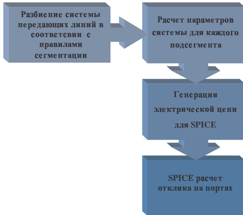
Рис. 7. Общая схема гибридного метода
