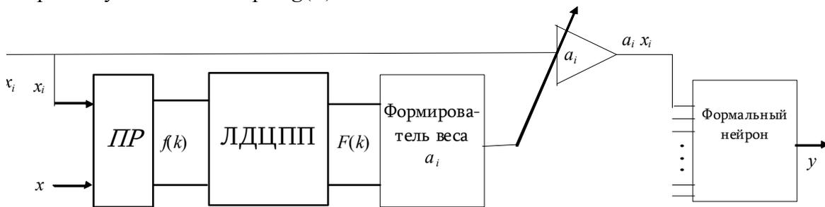
Рис. 4 ЛДЦПП в схеме релейной адаптации формального нейрона
